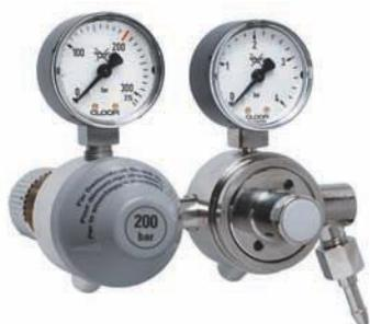
Zweistufiges Druckreduzierventil mit Anzeige des Flaschendruckes und des Arbeitsdruckes. Speziell geeignet für Anwendungen, welche einen sehr konstanten Hinterdruck erfordern (Hinterdruck fest eingestellt nach Wunsch zwischen 0,5 bis 3 bar). Ebenfalls für Analysegeräte mit teflonbeschichteter Membrane erhältlich.
