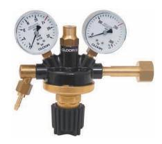
Druckreduzierventil mit Staudruckmanometer, d.h mit Angabe der Entnahmemenge in I/min auf dem Sekundärmanometer. Integriertes Sicherheitsventil. Dieses Druckreduzierventil ist eine günstige Alternative zur Ausführung mit Flowmeter Art. 5150. Bei diesem System wird der Durchfluss über die Veränderung des Hinterdruckes und durch eine Blende im Abgang geregelt.
