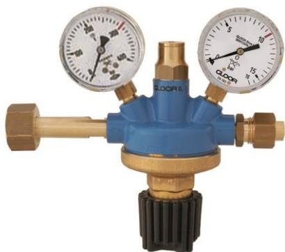
Ce manodétendeur a la même construction que l'Art. Nr. 5100 et est apte comme détendeur central pour des petites alimentations centrales en gaz. Comme option avec pression de travail jusqu'à 60 bar. Raccord à souder à la soupape de sécurité pour la déviation des gaz à l'extérieur.
