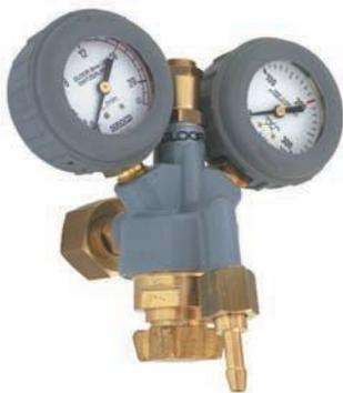
Klein-Druckreduzierventil mit Staudruckmanometer, d.h. mit Angabe der Entnahmemenge in l/min auf dem Sekundärmanometer. Integriertes Sicherheitsventil. Die Durchflussmenge wird mit der Regulierschraube über die Veränderung des Hinterdruckes und durch eine Blende im Abgang eingestellt.
