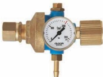
Druckreduzierventil mit Hochdruckmanometer (Durchmesser 40 mm) für die Anzeige des Flaschendruckes. Arbeitsdruck nach Wunsch des Kunden fest eingestellt bis 8 bar. Integriertes Sicherheitsventil.
