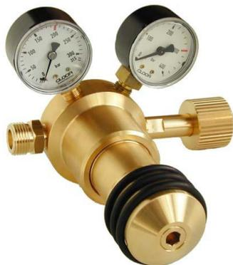
Le détendeur est disponible dans une version pour une pression de travail jusqu'à 100 bar ou jusqu'à 200 bar. La pression secondaire peut être ajustée au dispositif de réglage progressivement entre 10 – 100 bar, resp. entre 10 – 200 bar. Pour un ajustage facile de la pression, le dispositif de réglage a un hexagone en face, de manière que l'ajustement de la pression peut également être fait avec une clé pour vis à six pans creux 8 mm.
