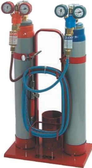
PROFILAM – die leichte und mobile Schweissausrüstung, bestehend aus Traggestell, für die Aufnahme je einer Sauerstoff- und Acetylenflasche Durchmesser 100 mm, zwei Klein-Druckreduzierventilen, zwei Flammendurchschlagsicherungen, Schläuchen, Brennerhandgriff, Schweisseinsatz Nr. 2, Brille, Gasanzünder, Gerät komplett montiert ohne Flaschen
