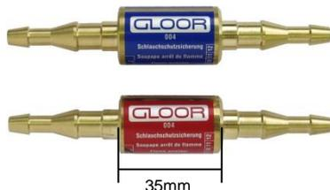
Mit den zwei Sicherheitskomponenten Gasrücktrittsventil und Flammensperre. Zur Montage im Schlauch mit Innendurchmesser 6 oder 8 mm.
